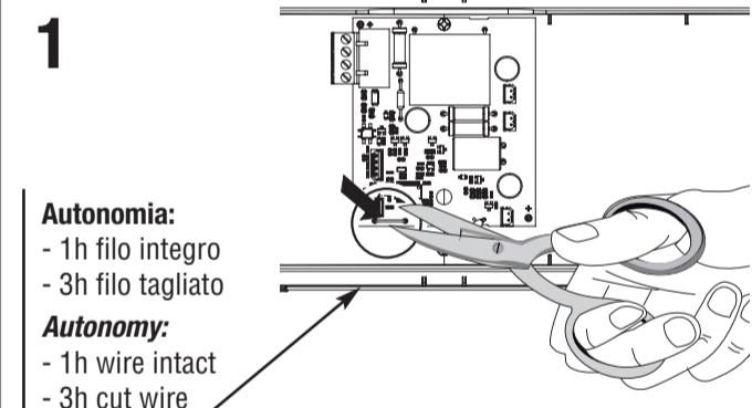
Connettere la batteria DOPO il taglio del filo per la selezione dell'autonomia
