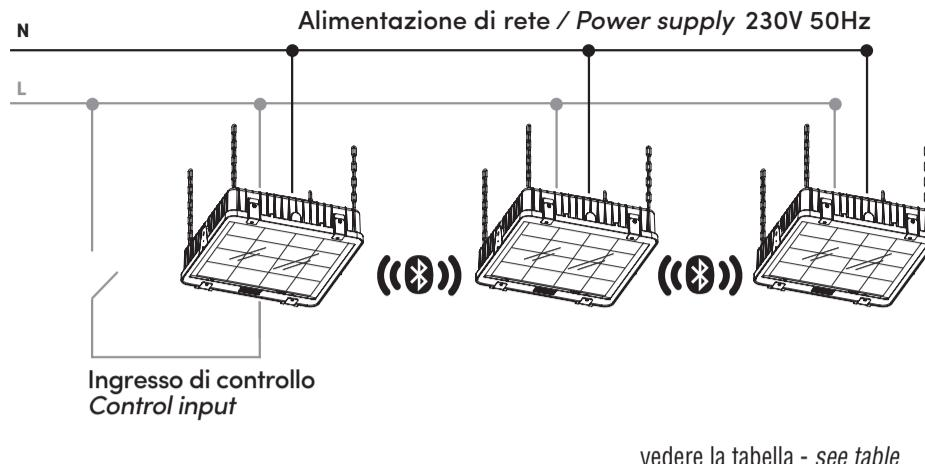
**E MONTAGGIO SENSORE AUTODIMMER-RADIO (COD. 15053-15054)**
