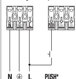
Collegamento di un sensore con uscita a 230VAC
