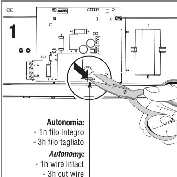
Cablaggio con Infinity mode (emergenza locale) disattivato - Cablaggio SE/SA
