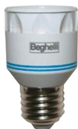
Un modulo anti black-out che si monta alla base di una lampadina LED o CFL\* aggiungendo così la funzione emergenza agli apparecchi di illuminazione co attacco E27. Autonomia senza rete elettrica: 2 ore.
