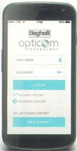
luminosi trasmessi dal flash dello smartphone e trasformarli in comandi per l'apparecchio stesso. Questa tecnologia di comunicazione, di tipo ottico bidirezionale, consente di modificare le prestazioni e le funzioni in emergenza degli Apparecchi con autodiagnosi AT (Autonomia, Flusso,
