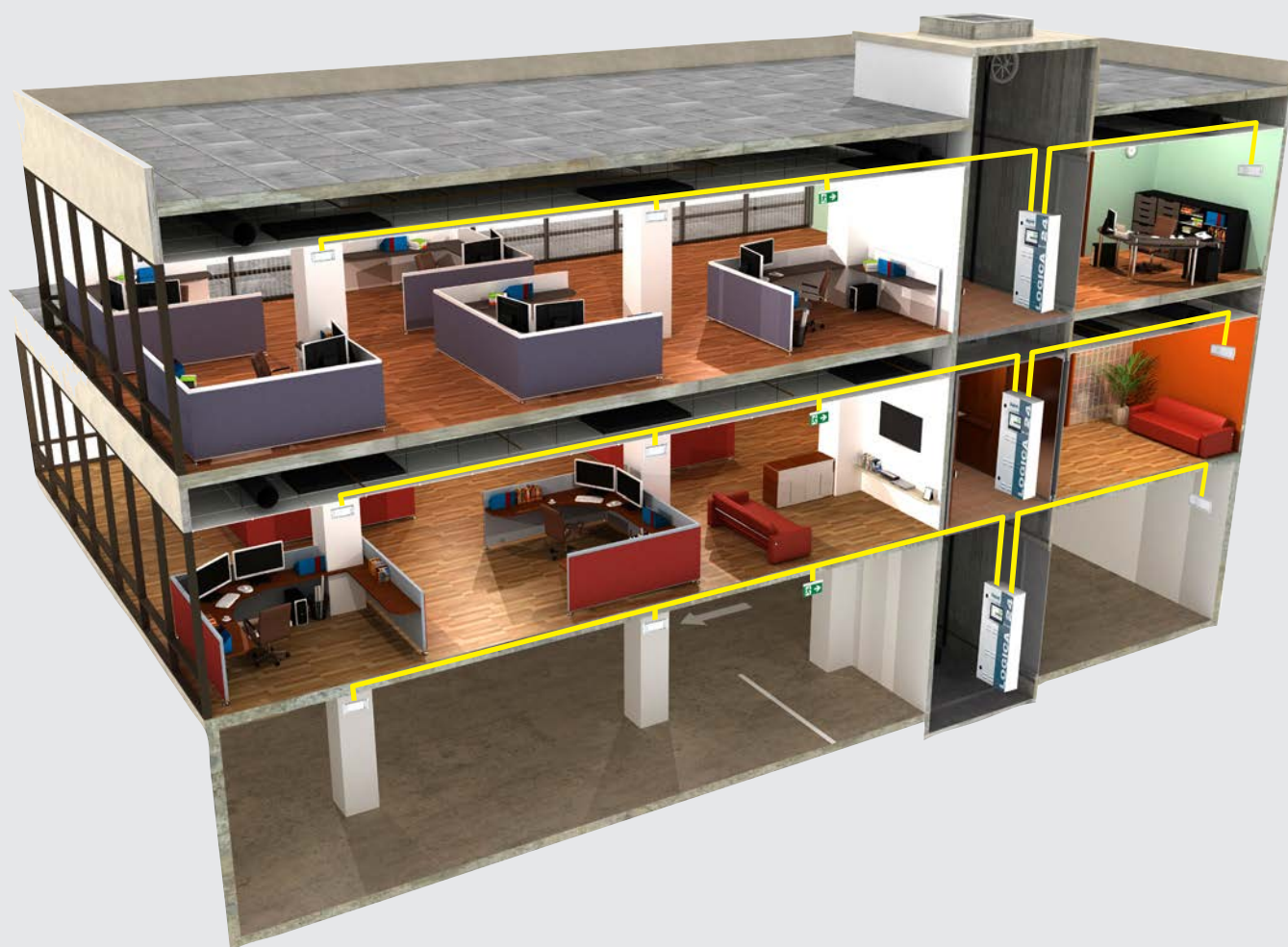
ESEMPLIFICAZIONE DI IMPIANTO LG24 FRAZIONATO CON PIÙ CENTRALI / EXAMPLE OF A SPLIT LG24 SYSTEM WITH SEVERAL POWER STATIONS
