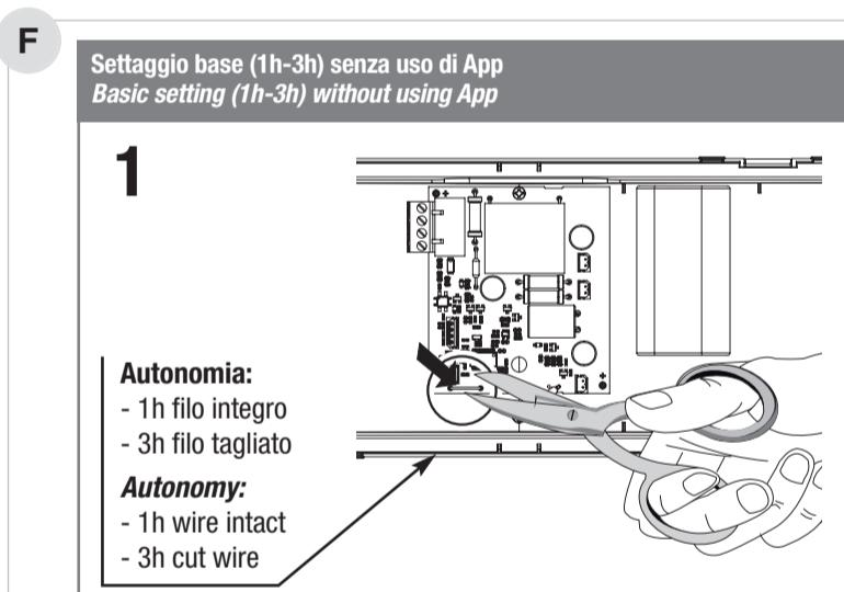
**!** Connettere la batteria DOPO il taglio del filo per la selezione dell'autonomia
