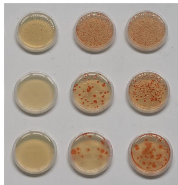
Analisi dei microorganismi in uscita dalla cella uvOxy®. Evidenza delle colonie di microorganismi utilizzati per le prove (in questo caso Serratia marcesces, un batterio molto più resistente del Covid-19). Le "macchie" indicano la crescita del batterio. Le piastre al centro e a destra mostrano i microorganismi cresciuti a lampada spenta, mentre a sinistra sono rappresentate le piastre all'uscita dalla cella a lampada accesa, dove non si osservano microorganismi cresciuti.
