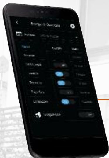
Con l'App Brain si può gestire l'intero impianto di riscaldamento programmando in modo differenziato le varie zone. Collocando una Placca Ipersenso in ogni ambiente, oltre a verificare temperatura e umidità, si può attivare il singolo collettore relativo.
