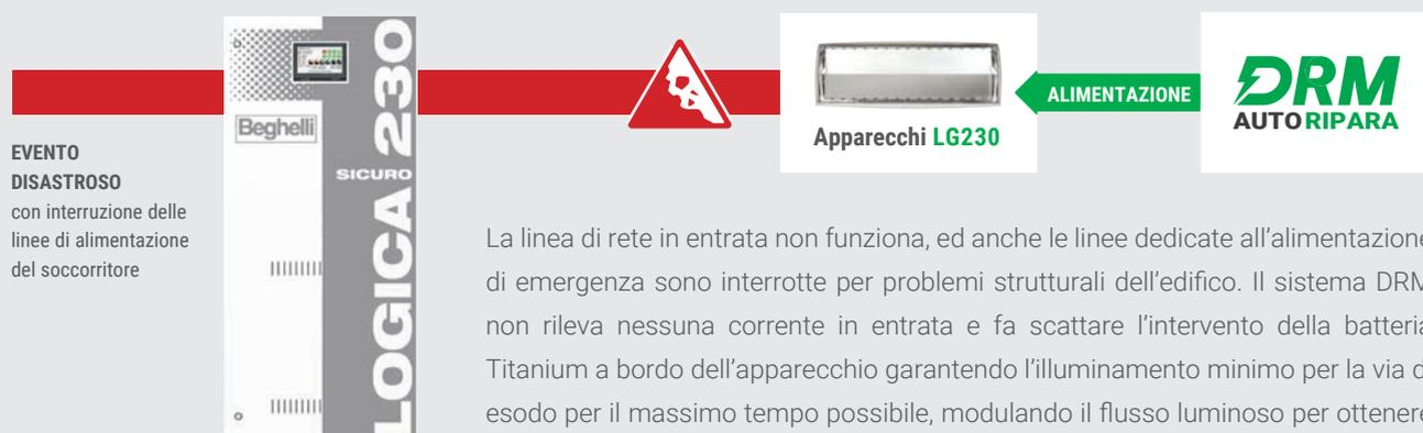
La linea di rete in entrata non funziona, ed anche le linee dedicate all'alimentazione di emergenza sono interrotte per problemi strutturali dell'edificio. Il sistema DRM non rileva nessuna corrente in entrata e fa scattare l'intervento della batteria Titanium a bordo dell'apparecchio garantendo l'illuminamento minimo per la via di esodo per il massimo tempo possibile, modulando il flusso luminoso per ottenere la massima autonomia
