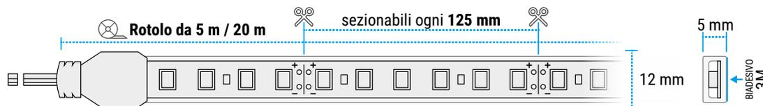
Kit completo con tutto l'occorrente per l'installazione di pezzi di strip sezionate dal rotolo originale. I connettori mantengono il grado di protezione IP della relativa strip.
