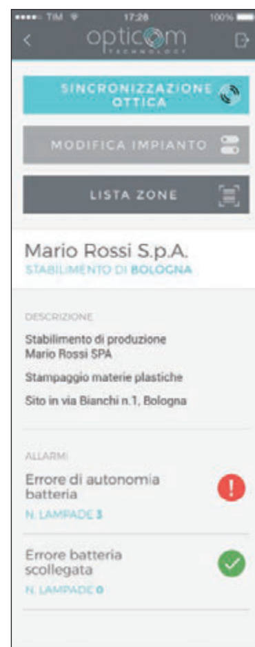
Szczegóły obiektu, gdzie zainstalowane są oprawy: opis systemu oraz pojawiających się błędów.
