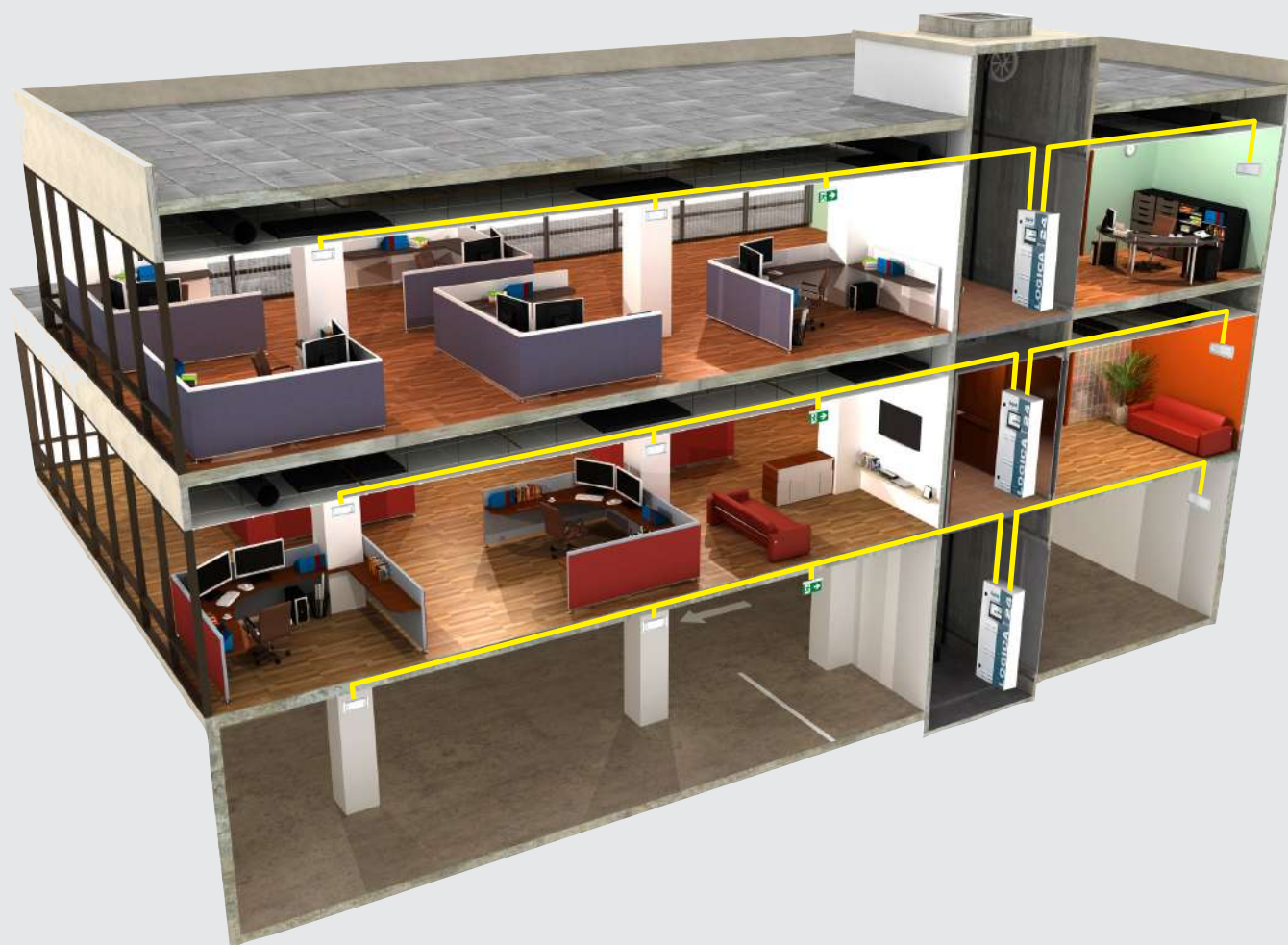
PRZYKŁAD ROZDZIELONEGO SYSTEMU LG24 Z KILKOMA STACJAMI GŁÓWNYMI / EXAMPLE OF A SPLIT LG24 SYSTEM WITH SEVERAL POWER STATIONS
