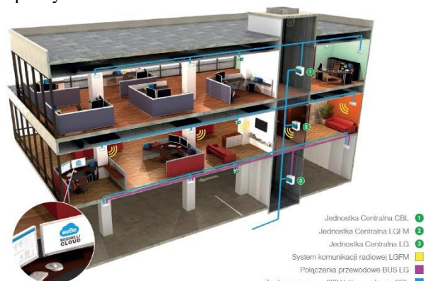
Rys. 10. Bezprzewodowa integracja różnych systemów zarządzania. [2]
