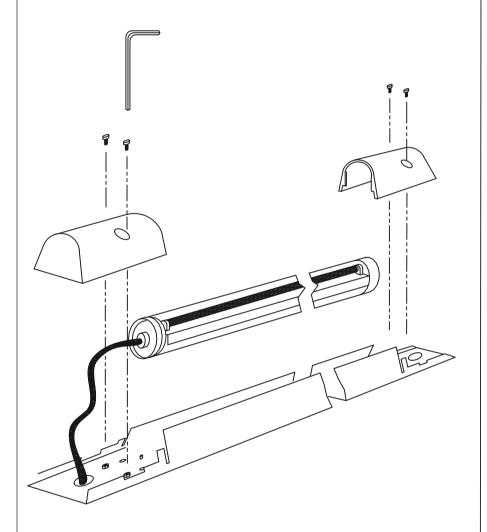
VÝMĚNA ZÁŘIVEK / TUBE REPLACING / ERSATZLAMPE
